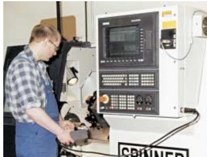
Modernste Technik als Basis für wettbewerbsfähige Forschung: Hier eine CNC-gesteuerte Drehmaschine in unserer GE „Mechanische Werkstatt“
