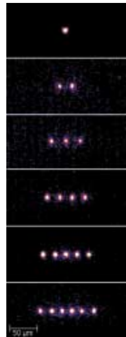
Mit Lasern gekühlte Kristalle aus einzelnen Ca^+ Ionen in einer Ionenfalle, aufgenommen mit einer CCD-Kamera
